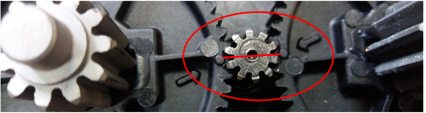
Abb. 9 – Räder Nr.2 RICHTIG eingesetzt
