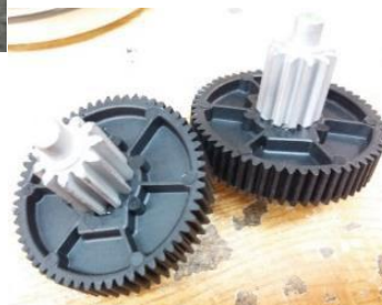
Abb. 5 – Räder Nr. 2 - Kunststoffräder PA 6.6 60GF
